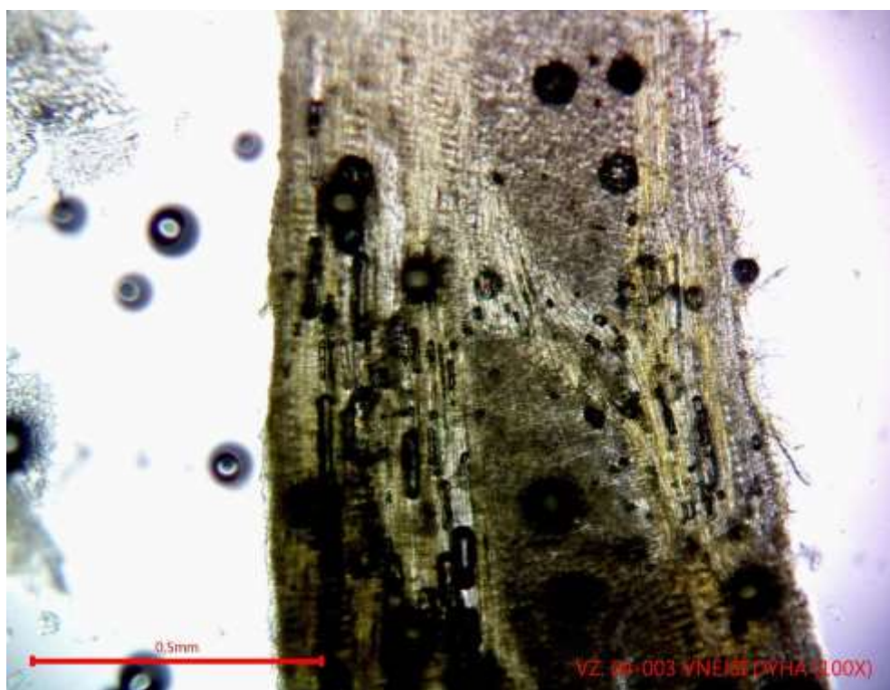
Mikroskopie, 04-003 vnější dýha - tangenciální řez, dub
