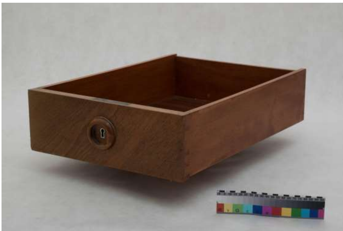
Zásuvka č. 1, tříčtvrteční pohled, viditelný polokrytý rybinový spoj
